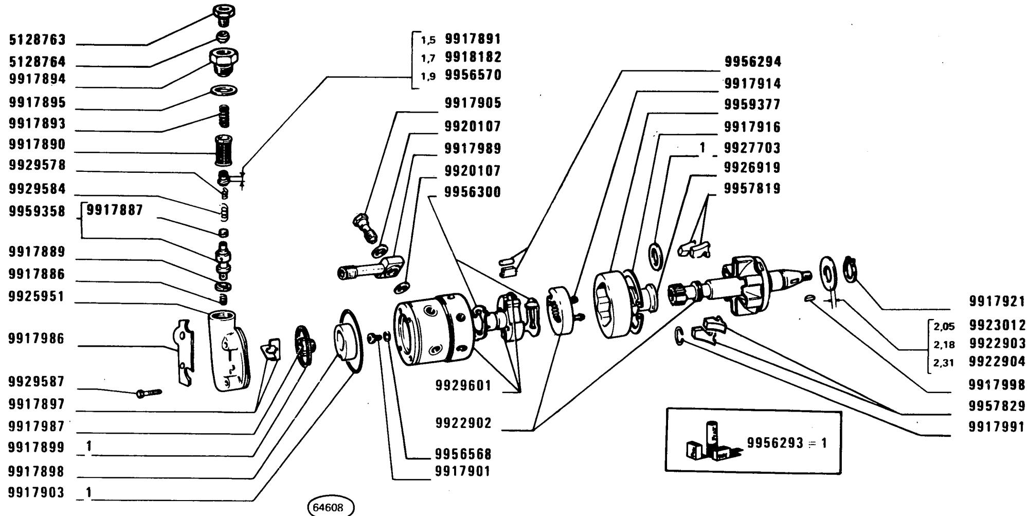
**POMPA INIEZIONE** 771541 (C.A.V.)**855 C**
